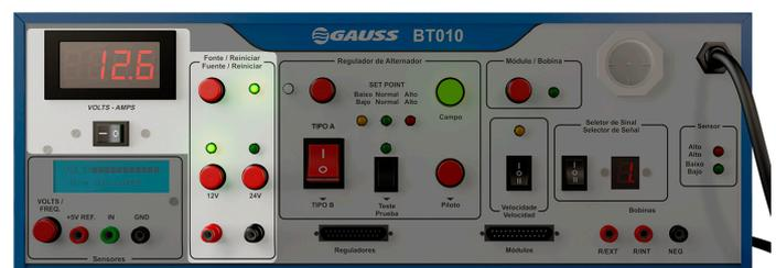
La pantalla digital muestra la tensión de CC o la corriente consumida. Debajo de la pantalla hay un interruptor que permite seleccionar la lectura de voltios o amperios.
