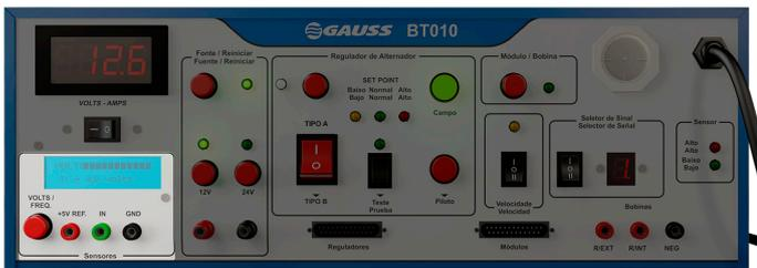
Está compuesto por una pantalla LCD de 2x16 caracteres, tres conectores y un botón de presión, lo que permite probar los sensores de acuerdo a lo descrito en el punto 3.1 - Prueba de Sensores.
