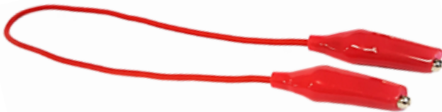
Fig. 5. Cable para conectar un “+” adicional.
